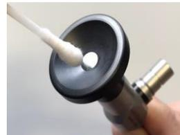
Abb.: Reinigen des Proximalen Fensters
