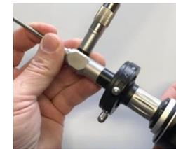
Abb.: Aufsetzen einer Endoskopie Kamera am genannten Okulartrichter
