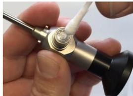
Abb.: Reinigen des Lichtleiteransatzes
